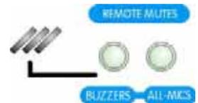
Der Schalter "ALL MICS" führt die Funktion einmalig beim Drücken aus. Die angeschlossenen Geräte (kabelgebundene und drahtlose Beltpacks, Tischgeräte, etc.) können ihre Mikrofone im Bedarfsfall wieder aktivieren. Beim Drücken des Schalters leuchtet die zugehörige LED für einen Moment auf.
