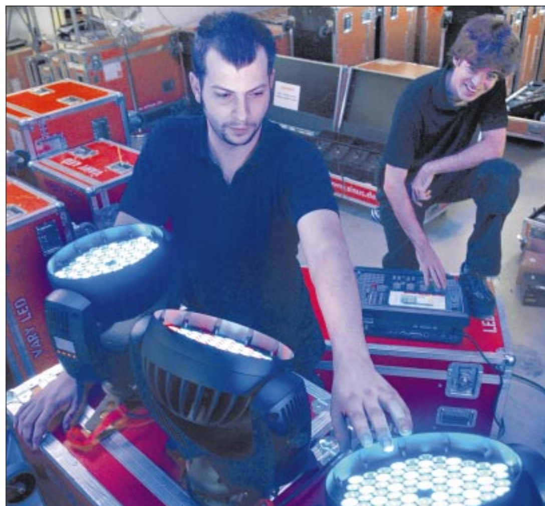
Lager der Lichteffekte: Die Event-Techniker Thomas Schneider (vorne) und Simon Rist prüfen im Lager der Darmstädter Sinus Event-Technik GmbH die „Moving Heads“. Das sind besonders helle LED-Scheinwerfer für den Bühneneinsatz. FOTOS: GÜNTHER JOCKEL
